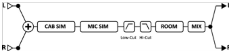
Figure 53 – La simulation de baffle stéréo
